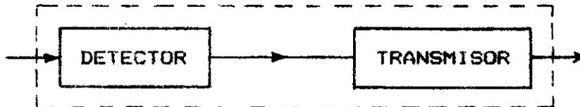
**DETECTOR:** Dispositivo que está en contacto con la variable controlada, entregando una *señal arbitraria*, según su principio de funcionamiento.
