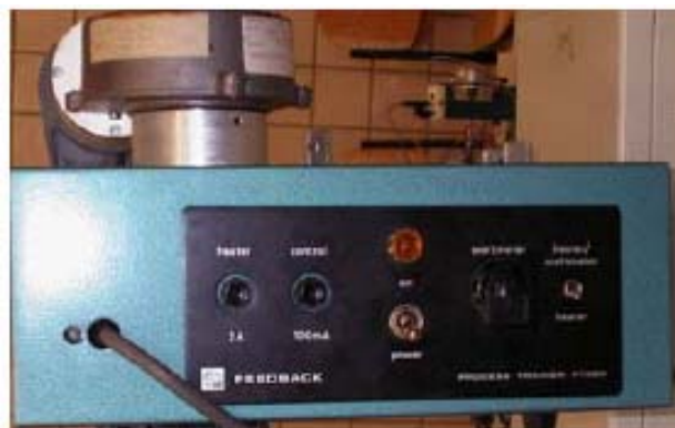
Vista Lateral – control de encendido general y del calefactor
